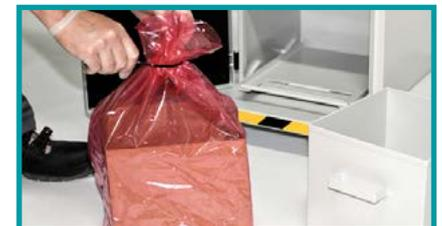
Die Entsorgung des im Prozess anfallenden Staubs erfolgt über den entnehmbaren Staubsammelbehälter.
