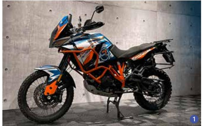
Diese Folie wurde speziell für die Verwendung als Deko-Set von Fahrzeugen, die für die Ausübung von Extremsportarten bestimmt sind, entwickelt. Polymerfolie in einer Stärke von 100 µm, die einfach anzubringen ist und über einen Klebstoff mit erhöhter Stoss-, Reibungs- und Vibrationsfestigkeit verfügt. Damit wird eine optimale Haftung auf Kunststoffoberflächen (Karosserieteilen usw.) gewährleistet.
